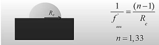
Figure 2 Schéma et photographie de la goutte d'eau.
